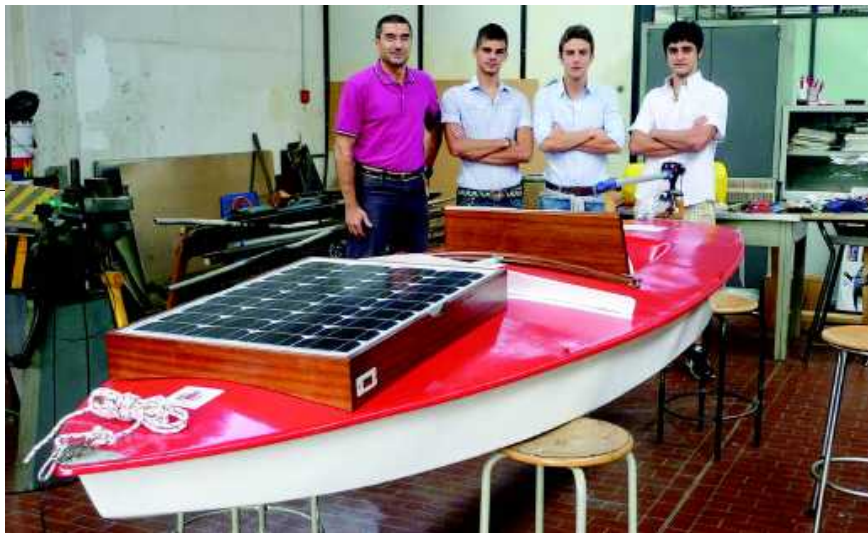
L'imbarcazione abbandonata, trovata sul lago di Viverone, è stata rimessa in sesto e alimentata con pannelli solari
